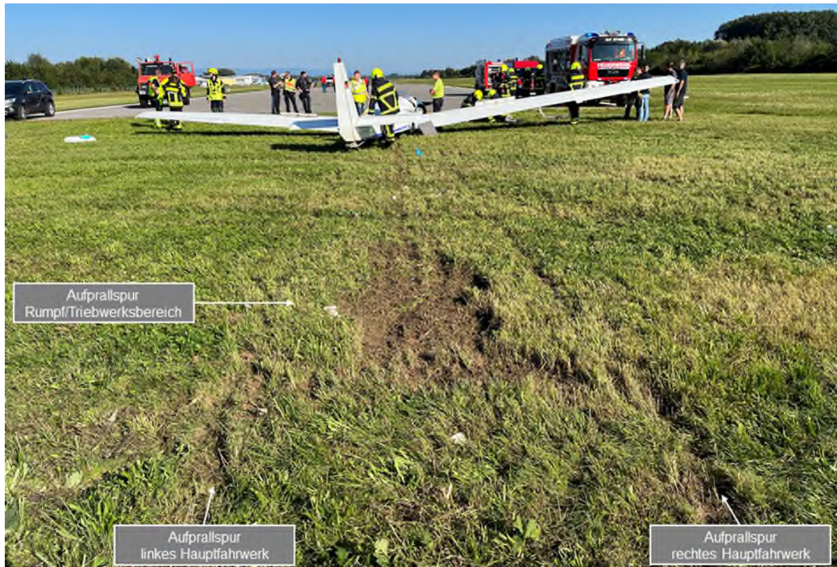
Abb. 4: Aufprallspuren und Endlage des Motorseglers
