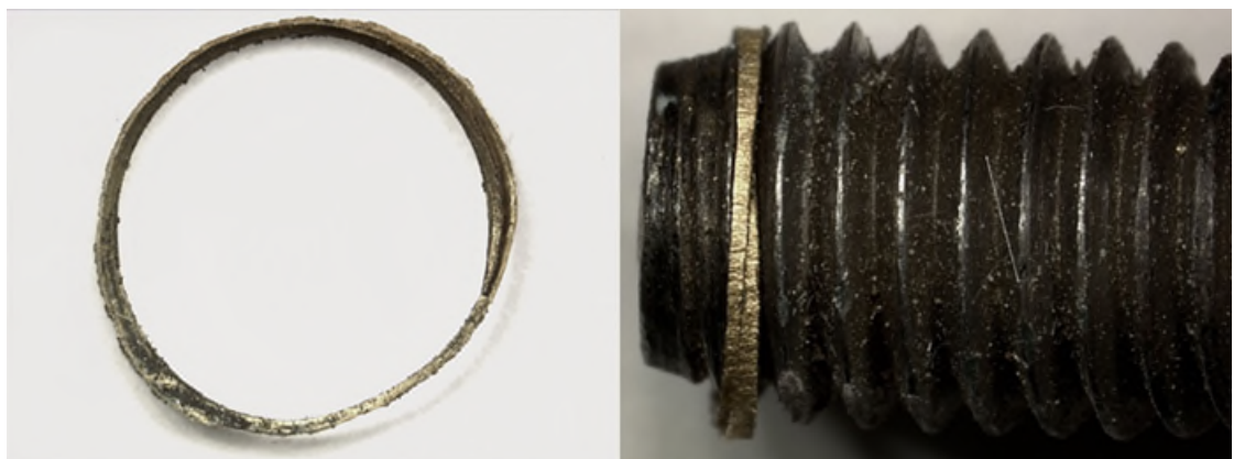
Abb. 13: Gewindegang im Detail (links) und Gewinde der Spannschlossschraube mit Gabel mit dem ersten Gewindegang der Spannschlossmutter
