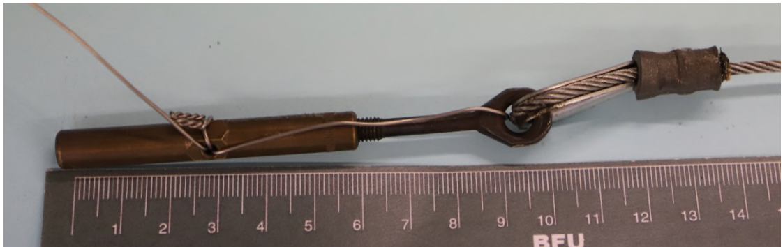
Abb. 12: Spannschlossmutter und Spannschlossschraube mit Öse und Sicherungsdraht Quelle: BFU
