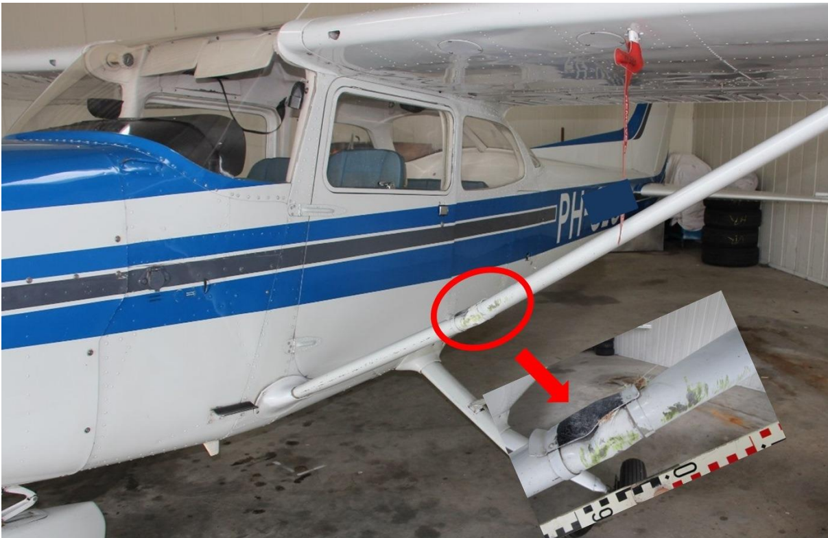
Abb.7: Cessna 172 N mit beschädigter linker Strebe
