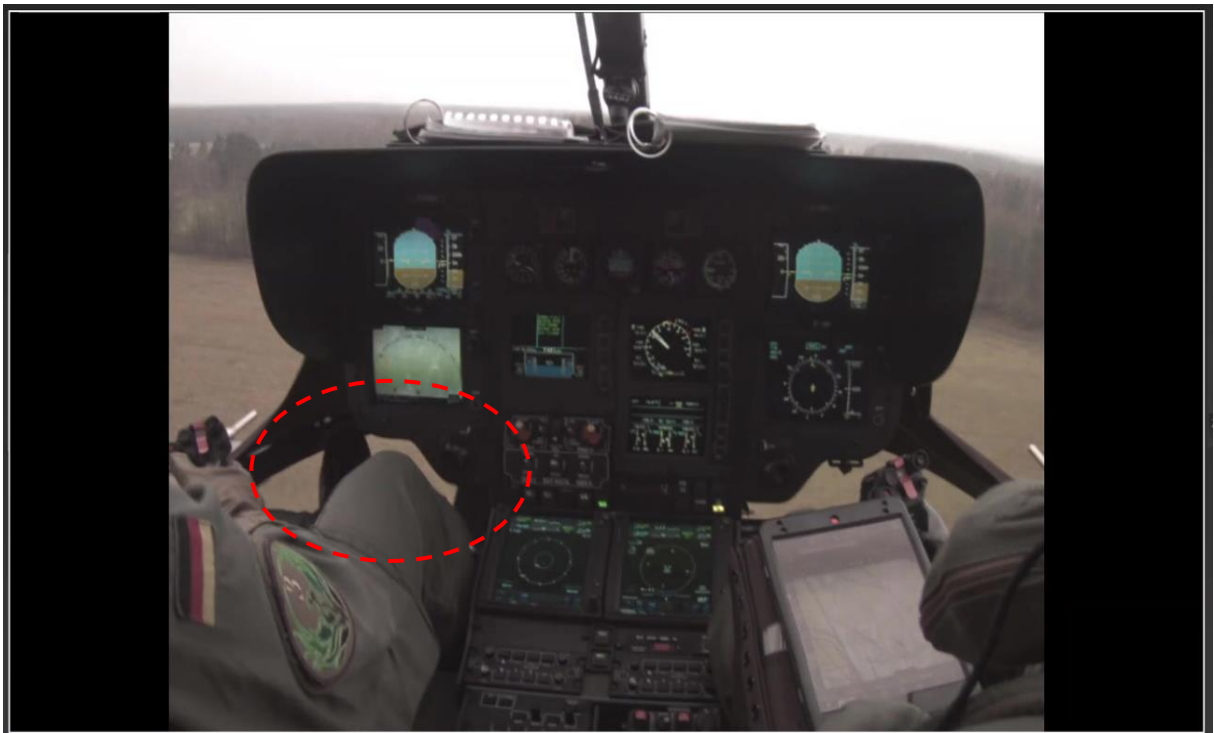
Abb. 5: Cockpitkamera-Aufzeichnung unmittelbar zu Beginn der Drehung nach rechts sowie die Position der Füße des Piloten auf den Pedalen
