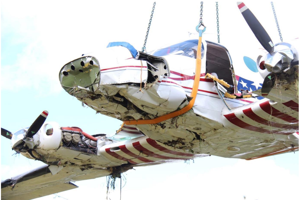
Abb. 11: Beschädigungen am vorderen Rumpf
