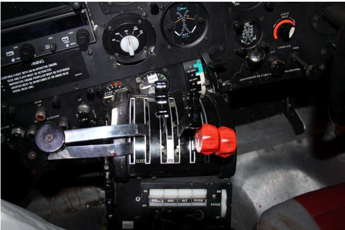
Abb. 12: Verdrehte Mittelkonsole mit Triebwerksbedienhebeln
