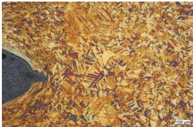
Geätzt sind inhomogene Korngrößen erkennbar
