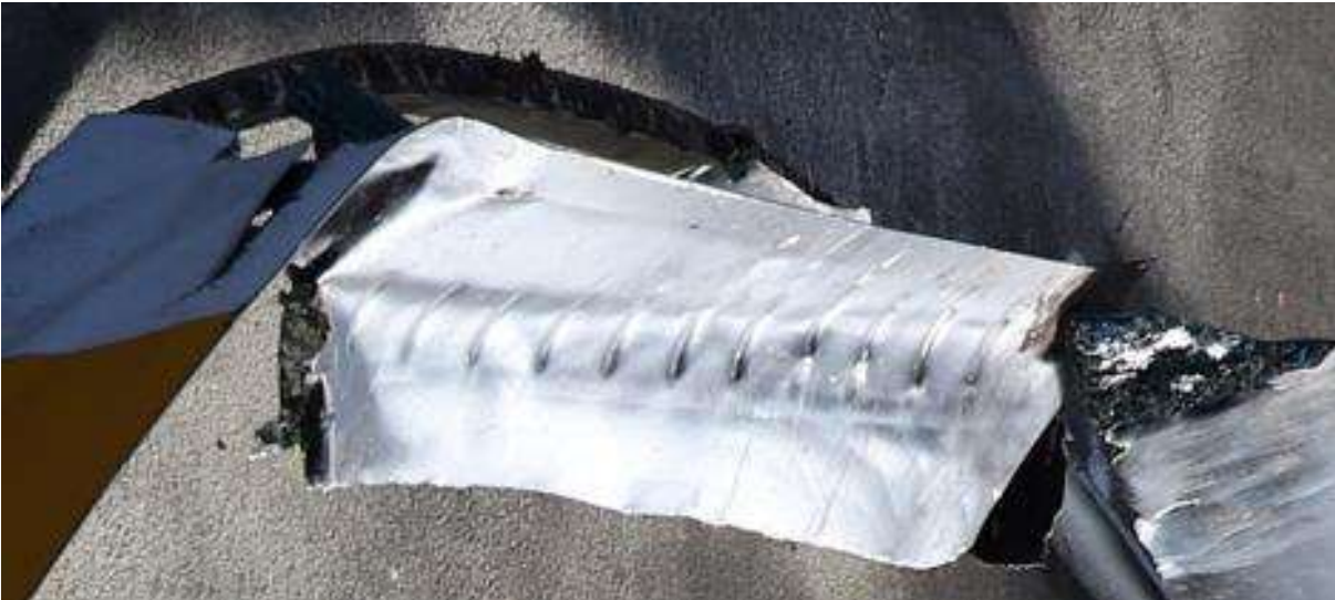
Abb. 8: Einschlagspuren der Schraubenköpfe der mittleren Cockpitverglasungsstrebe an der Unterseite von einem der beiden Rotorblätter
