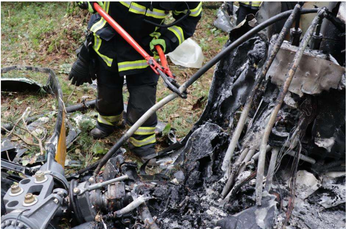
Abb. 6: Steuerstangen im Bereich Kabine und Taumelscheibe
