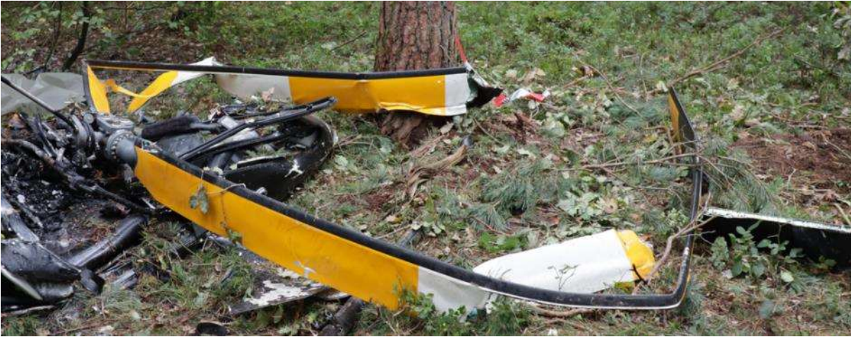
Abb. 7: Beschädigungen an den Rotorblättern
