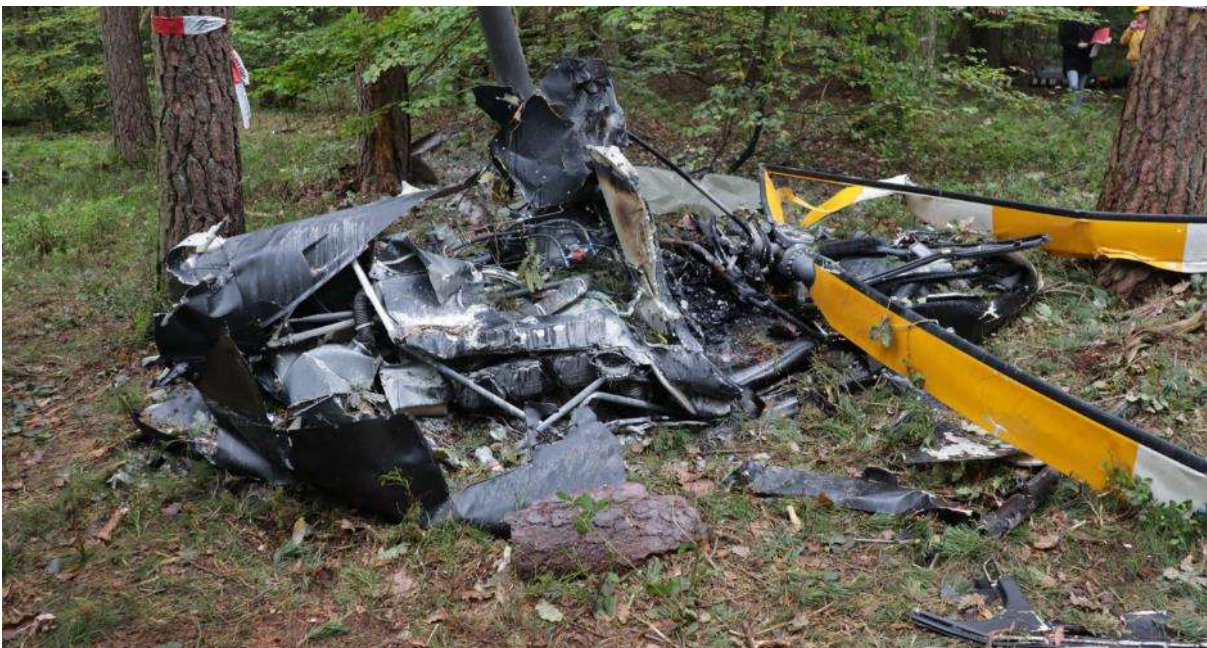
Abb. 5: Hauptwrack des Hubschraubers mit abgebrochenem Rotorkopf
