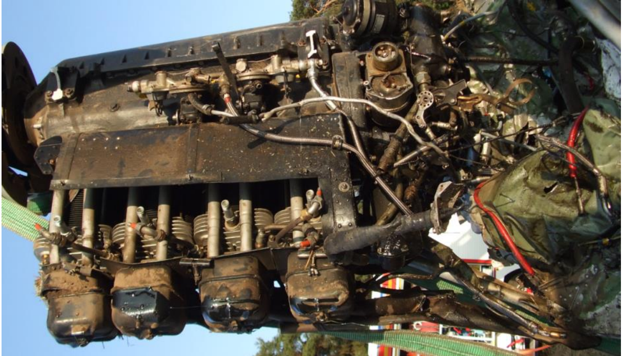
Abb. 5: Beschädigungen im Bereich der Anbauaggregate des Motors
