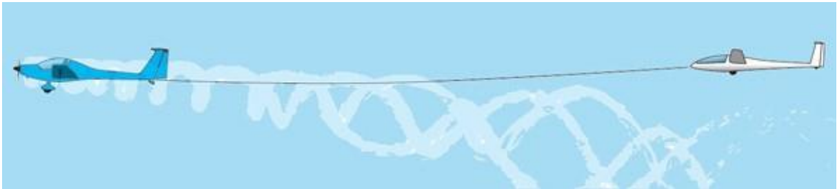
Abb. 7: Position hinter dem Schlepluftfahrzeug; Wirbelschleppe Quelle: Bundeskommission Segelflug im DAeC
