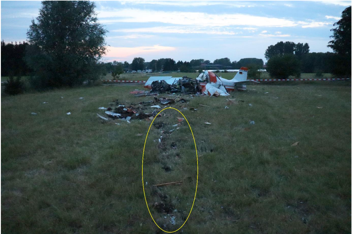
Abb. 6: Aufprallspuren der linken Tragfläche und des Rumpfbugs in Relation zum Hauptwrack
