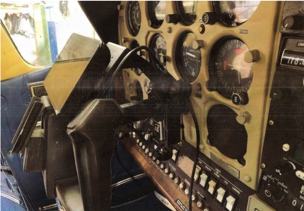
Abb. 3: Montageposition des GPS am 25.06.2019 nach dem Unfallflug
