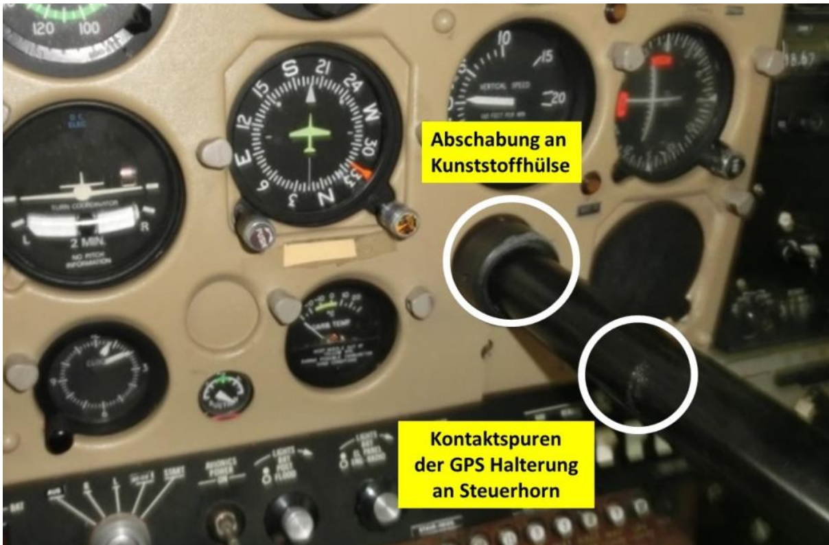
Abb. 5: Kontaktspuren an der Steuerung, aufgenommen am 17.10.2019
