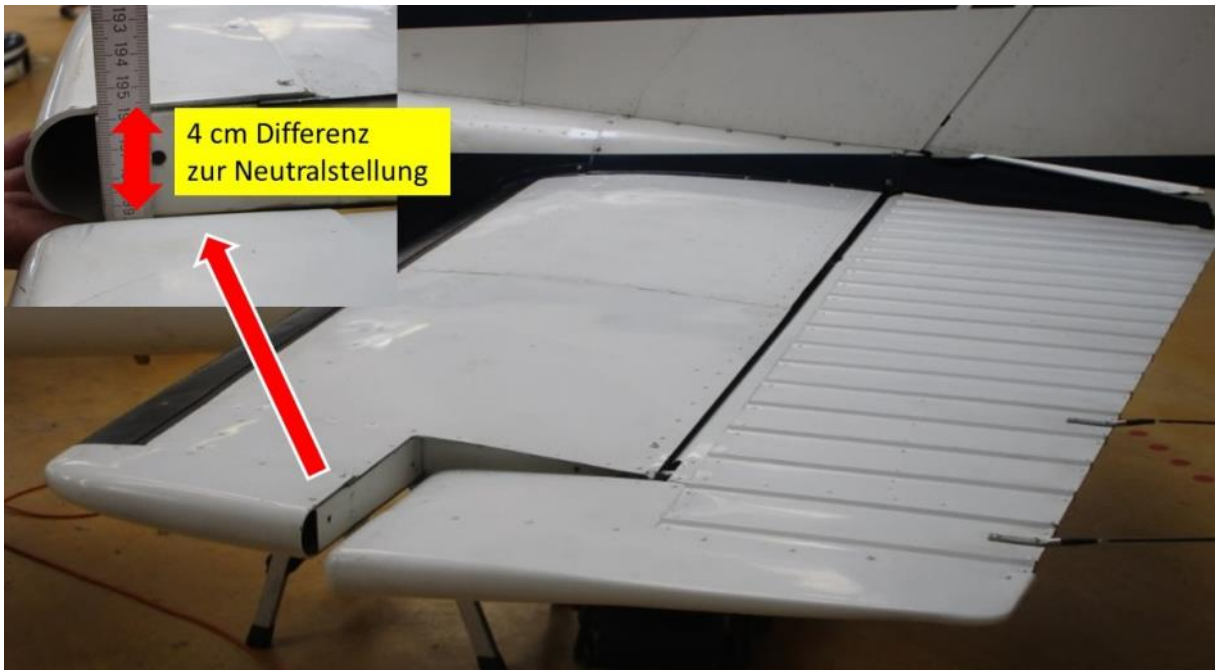
Abb. 7: Ausschlag Höhenruder bei nachgestellter GPS-Montage, aufgenommen am 17.10.2019
