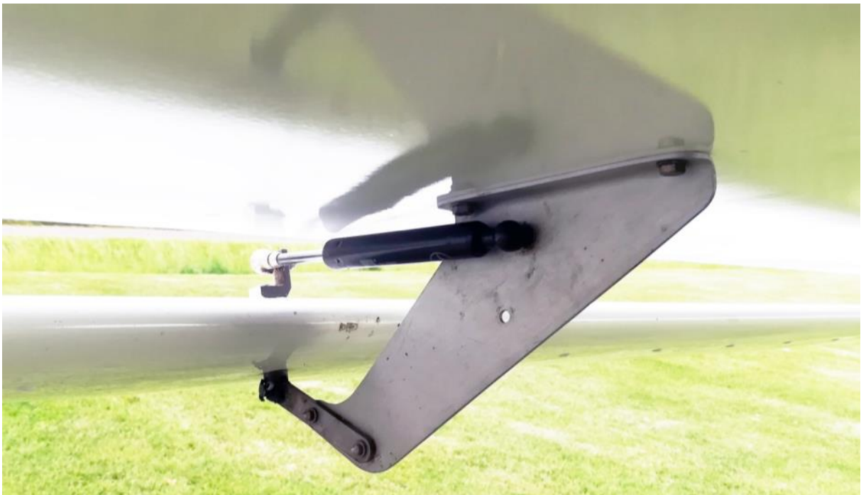
Abb. 3: Querruderhalter mit Gasdruckfederdämpfer
