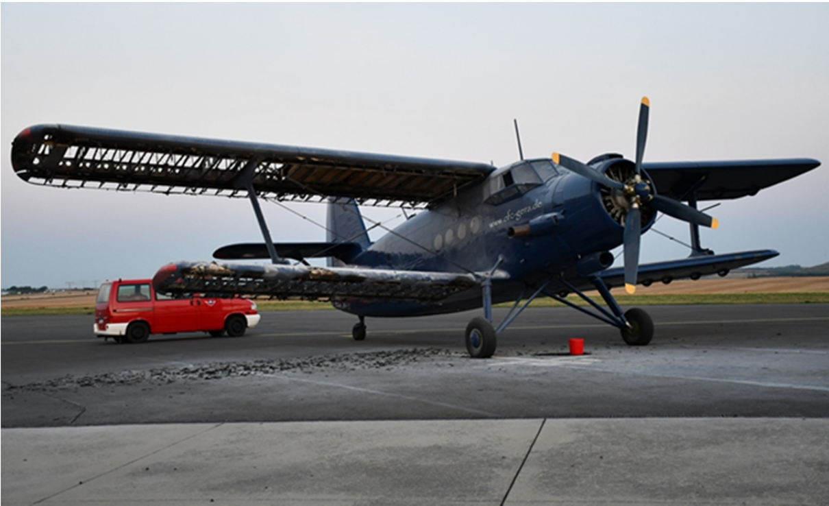
Abb. 4: Die Antonov AN-2 mit den verbrannten Tragflächen nach dem Brand,
