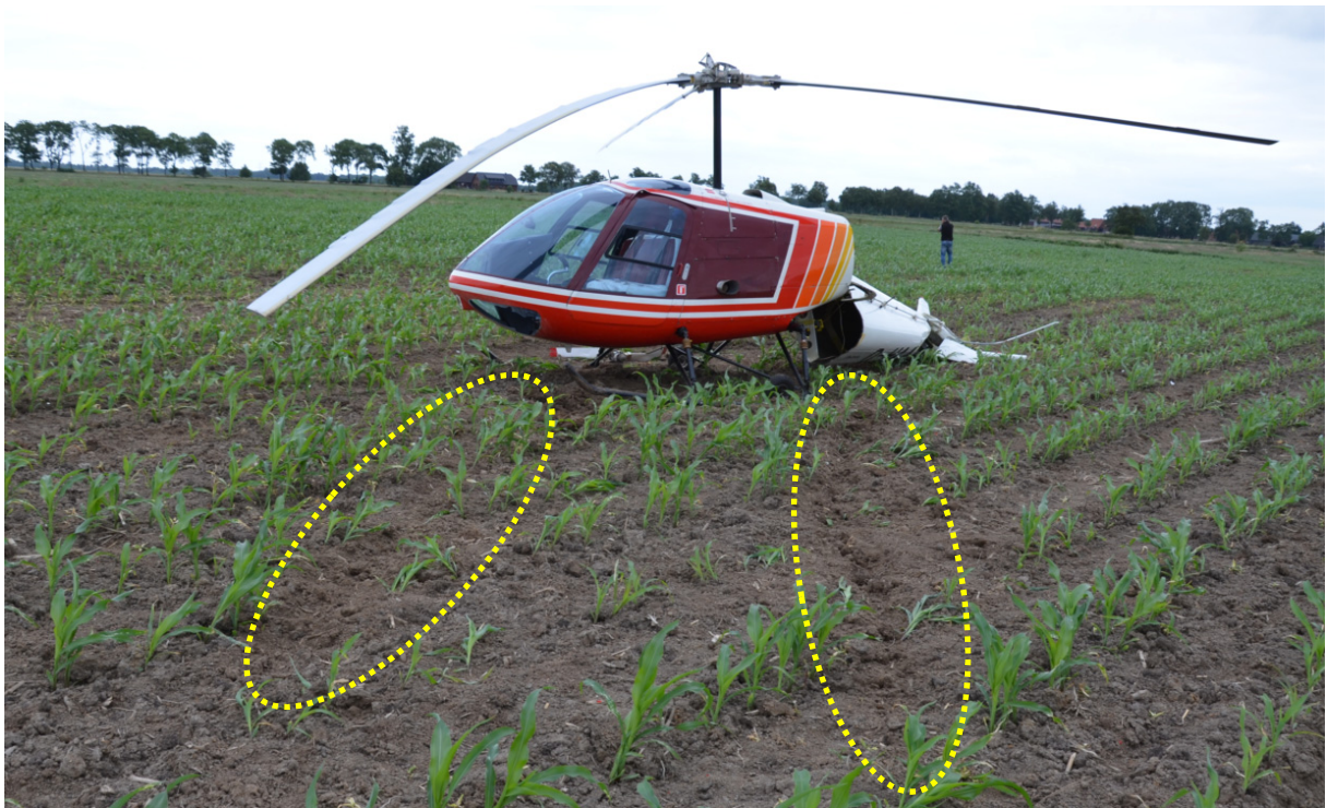
Übersicht Beschädigungen am Hubschrauber und Bodenspuren
