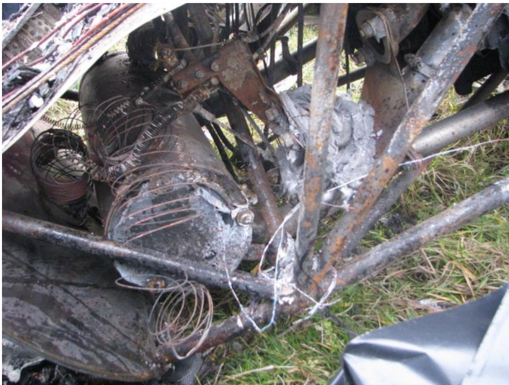
Abb. 4: Blick von rechts, Bildmitte: der geschmolzene Vergaser, links der Schalldämpfer und die Drahtwendel der Luftschläuche, rechts oben das Ansaugrohr der rechten Zylinderbank
