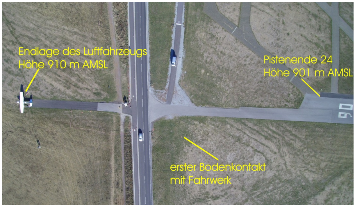
Abb. 1: Übersicht der Unfallstelle mit Bodenspuren am Pistenende und Endlage des Luftfahrzeuges
