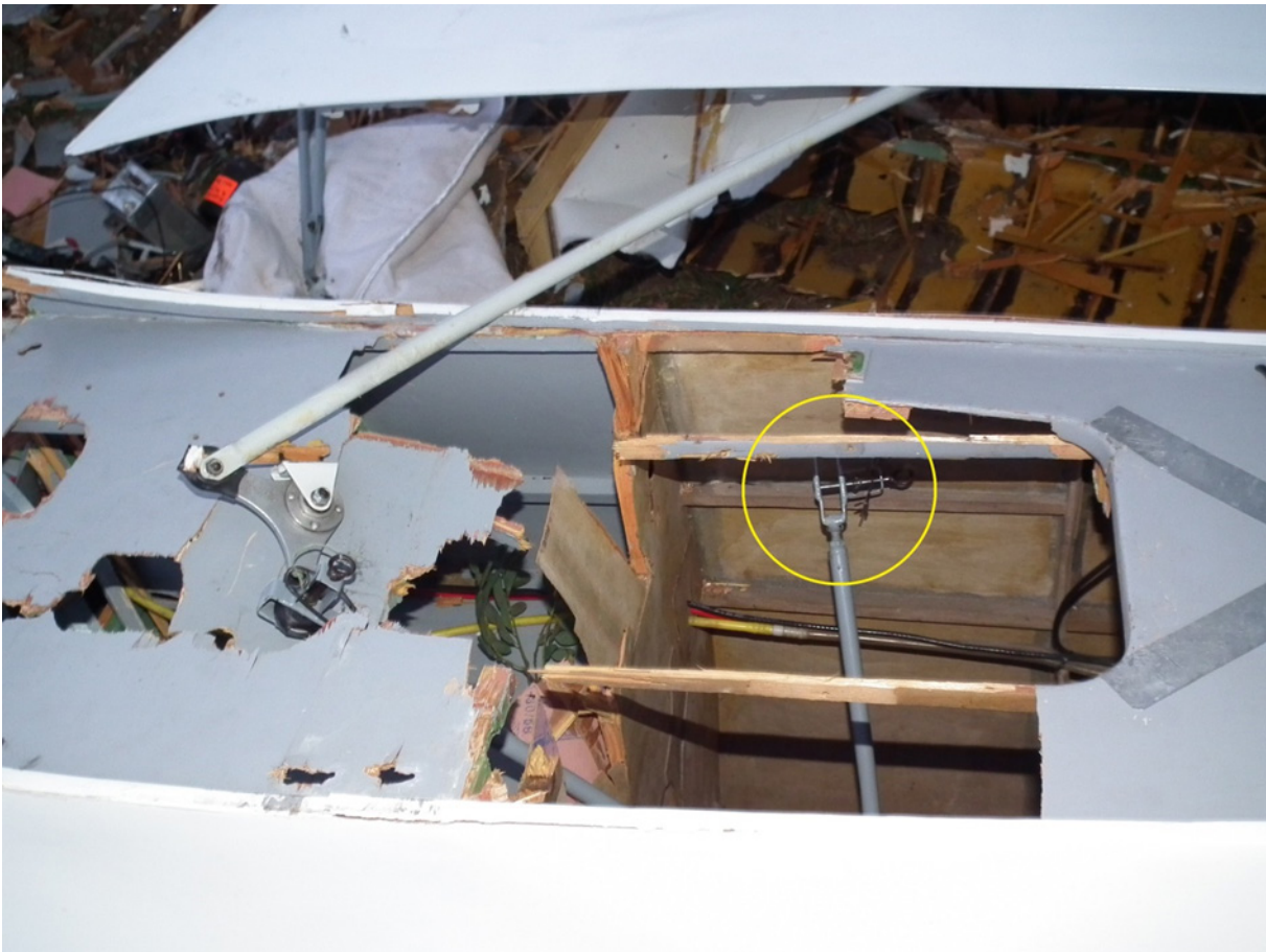
Abb. 4: Anschlussbereich im Rumpf, Querruderanschluss markiert
