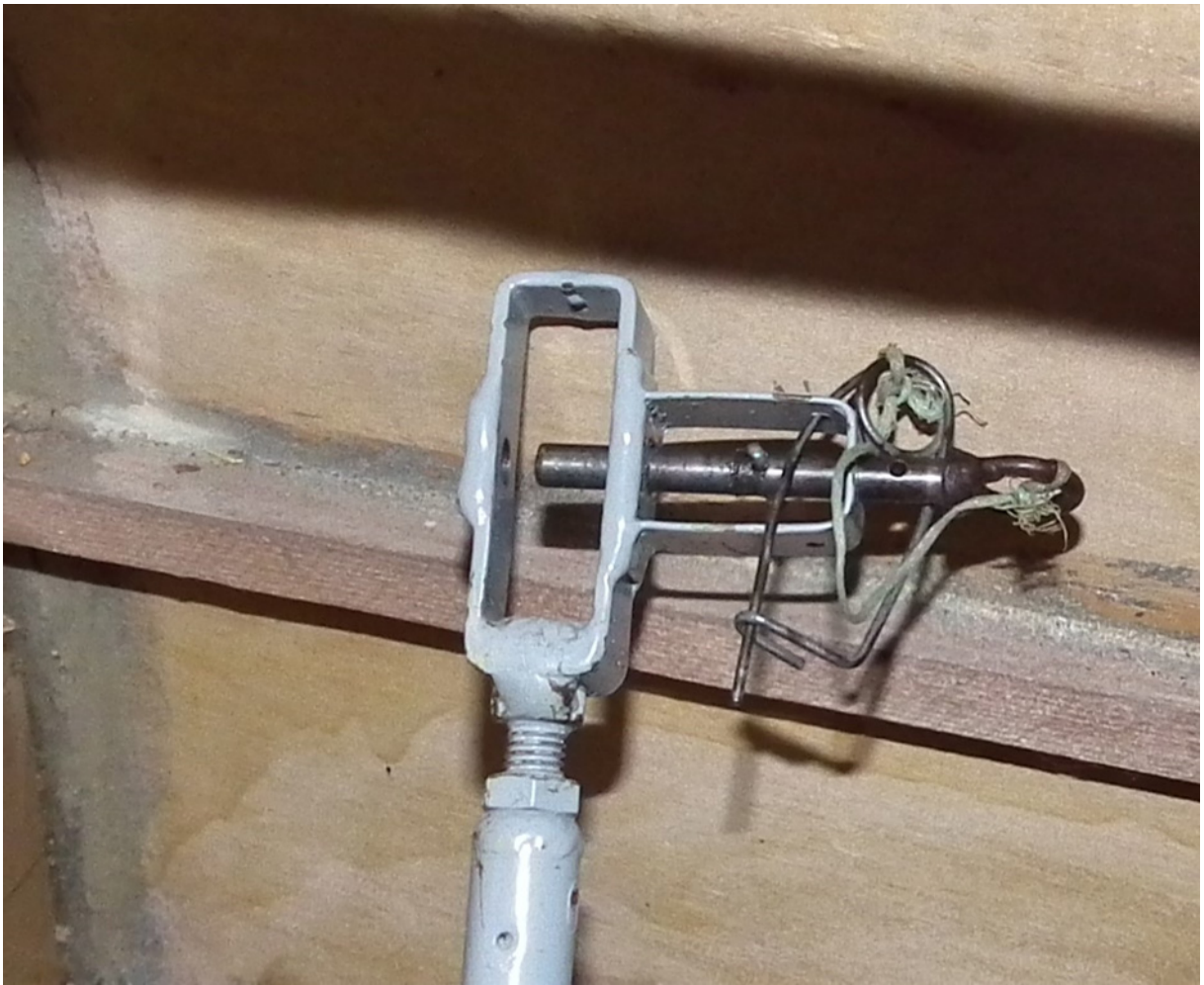
Abb. 5: Auffindsituation des Ruderanschlusses, Fokkernadel am Bolzen vorbeigeführt, Bolzen im Rahmen zurückgerutscht
