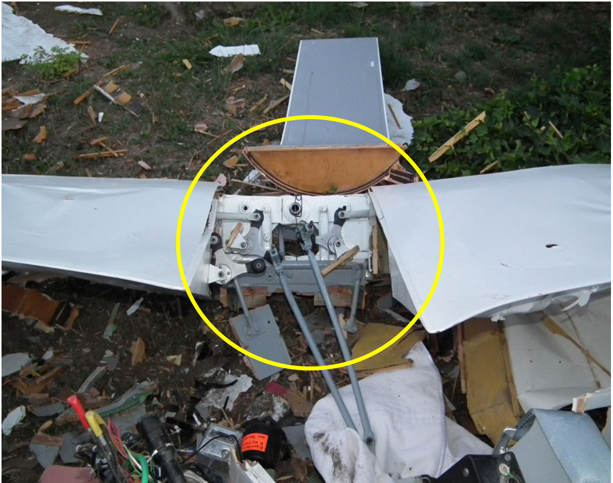
Abb. 3: Tragfläche Mittelteil, Anschlussbereich
