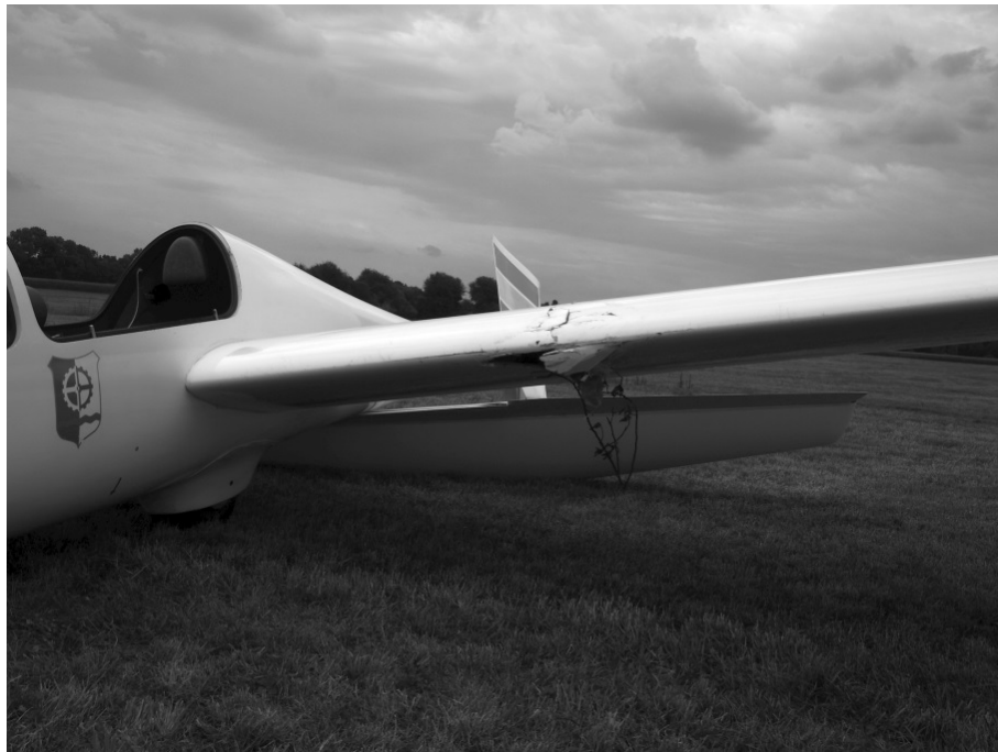
Beschädigung der linken Tragfläche durch Hindernisberührung
