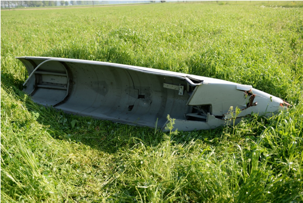
Abb. 1: Fundort der Verkleidung des Landklappenantriebs
