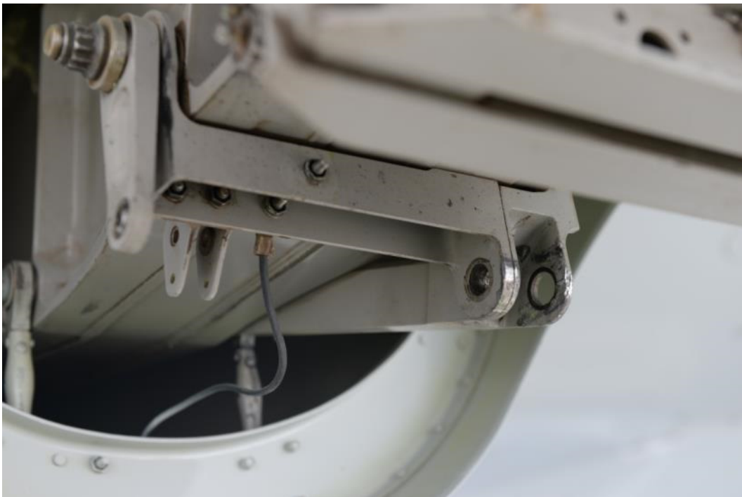
Abb. 4: Vordere Befestigungspunkte an der Klappenführungsschiene
