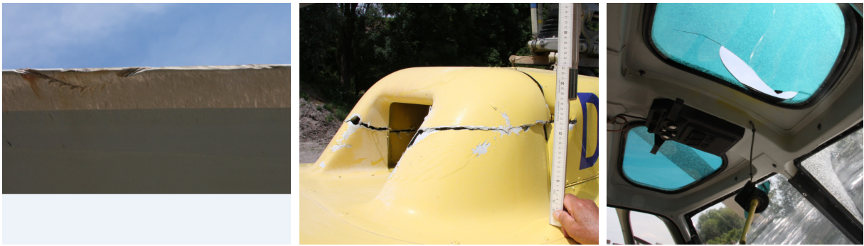
Schäden nach Freileitungsdurchflug
