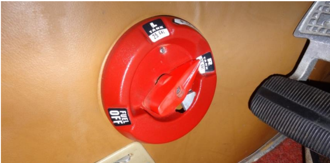
Abb. 3: Tankwahlschalter, Stellung: R Tank
