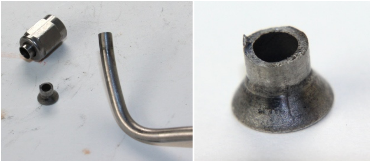
(10 und 11) Bruchbereich der Kraftstoff-Leitung mit leichter Rohrkrümmung und Detailaufnahme Quelle: BFU
