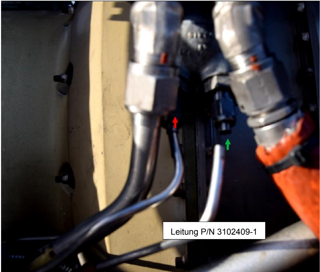
(4) Anschluss der Kraftstoffleitung an der Kraftstoff-Heizung
