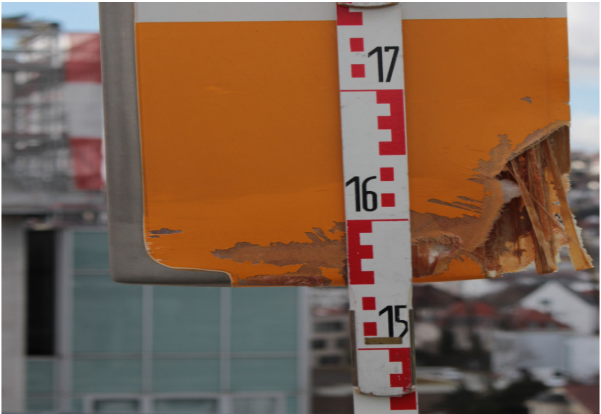
Beschädigungen am Heckrotorblatt und Höhe über Grund
