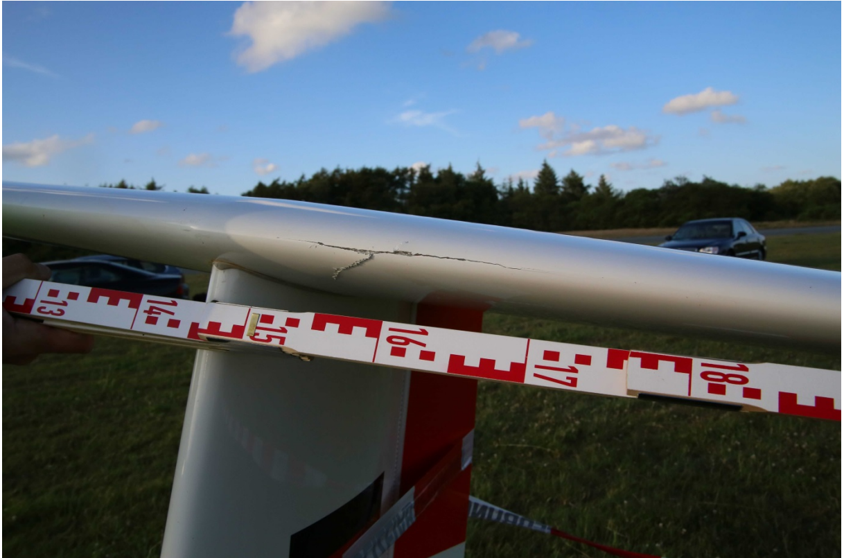
Beschädigung am Höhenleitwerk
