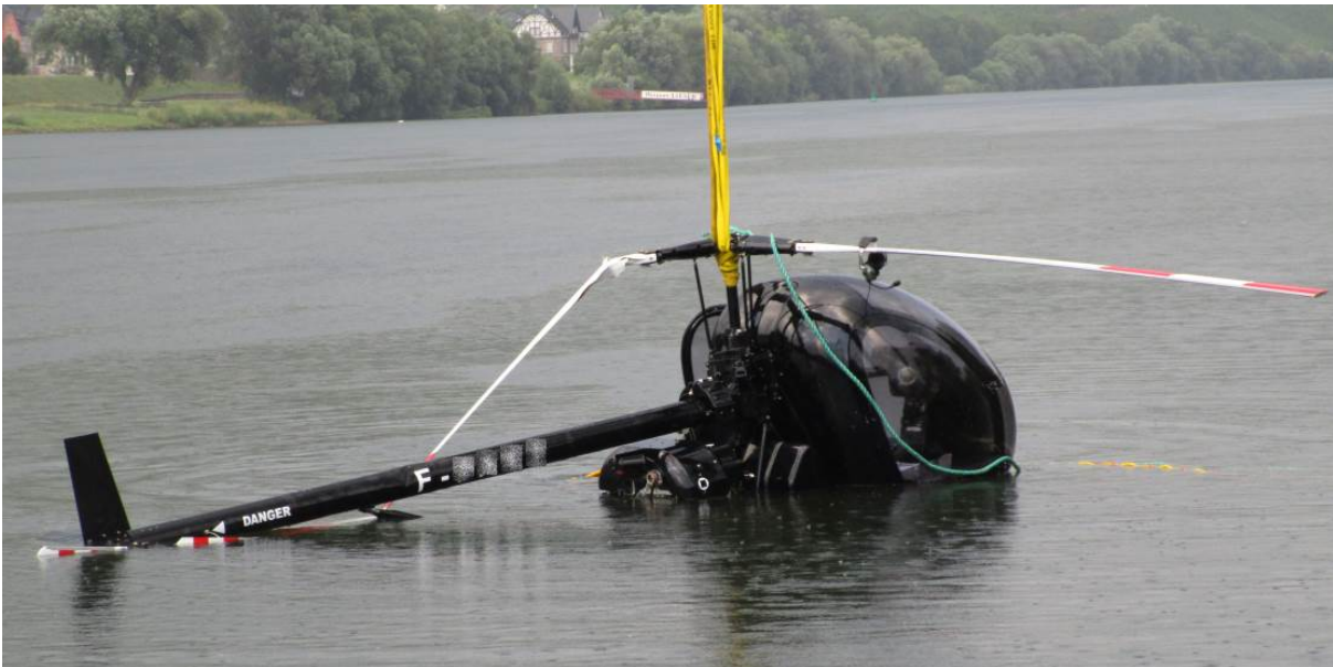
Beschädigungen des Hubschraubers am Rotor sowie Heckausleger
