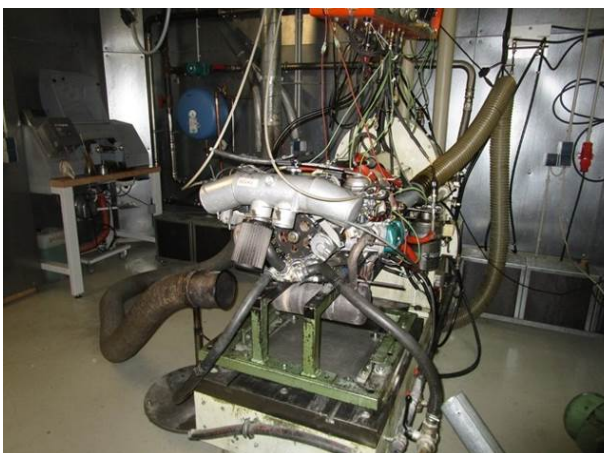
Untersuchung und Testlauf des Triebwerkes in einem Fachbetrieb
