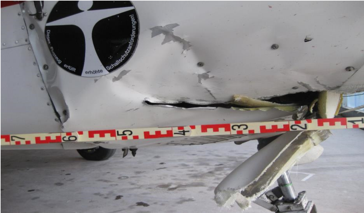
Schäden an der Motorverkleidung
