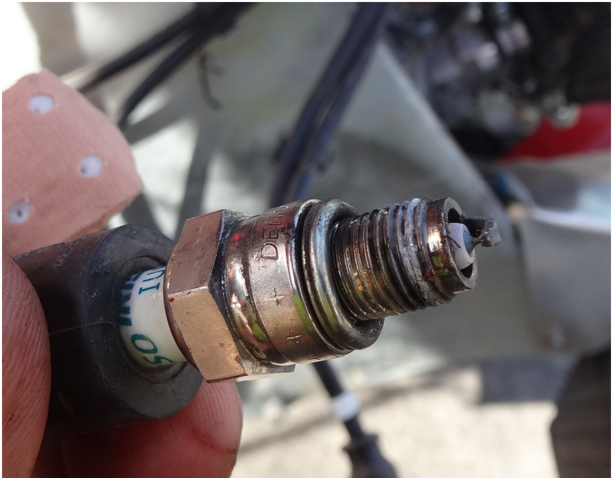
Zündkerze des vorderen Zylinder
