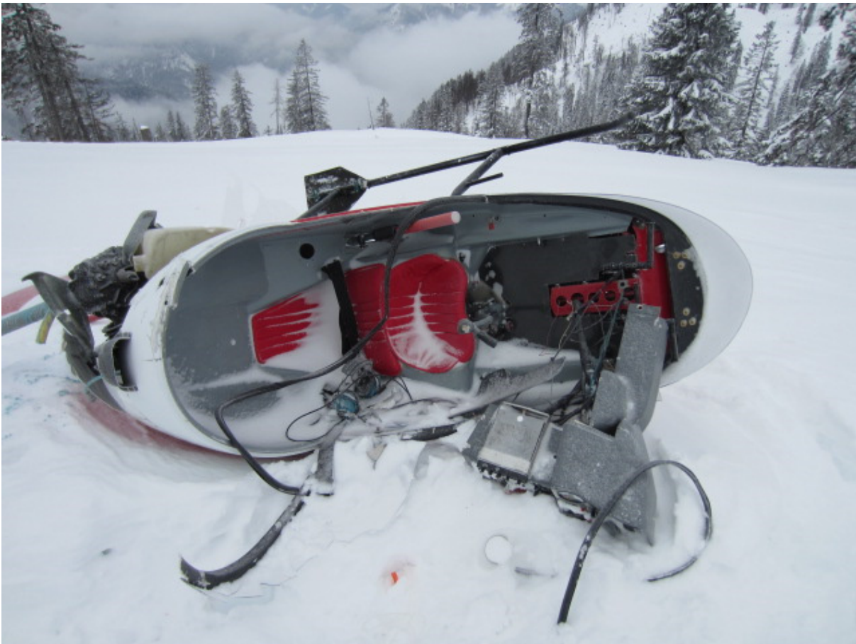
Überblick Beschädigung des Cockpits und des Instrumentenpilzes
