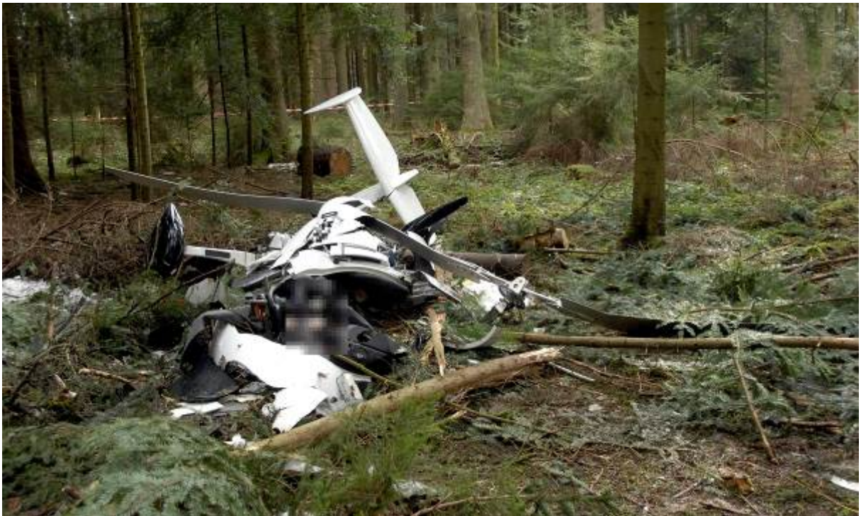
Übersicht Tragschrauberwrack mit Rotorverformung
