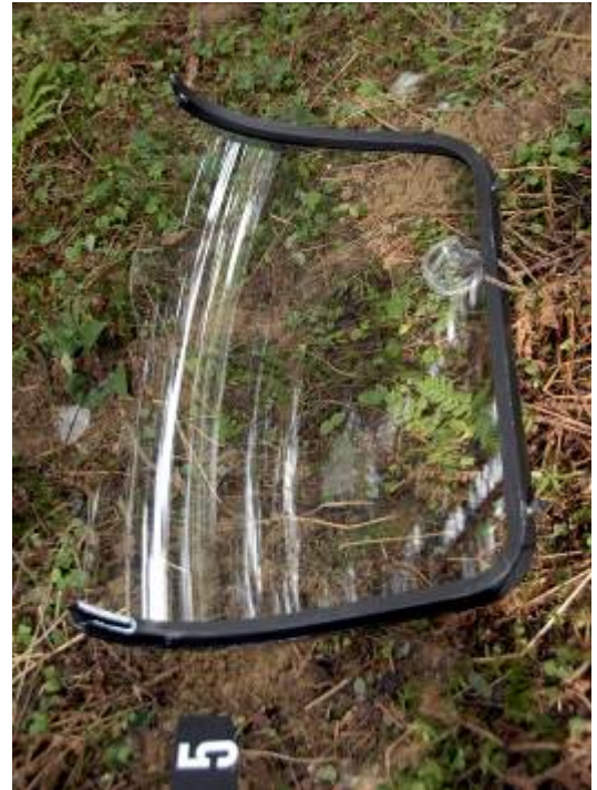
Von der Unfallstelle 75 m bzw. 200 m entfernt gefundene Haubenstücke
