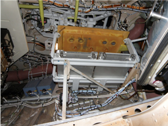
Einbauort des Radar Transceiver mit leichten Rußantragungen an der Oberseite
