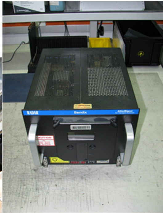
Radar Transceiver im ausgebauten Zustand
