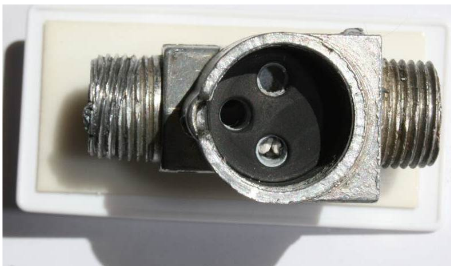
Kraftstoffhahn mit Verunreinigungen
