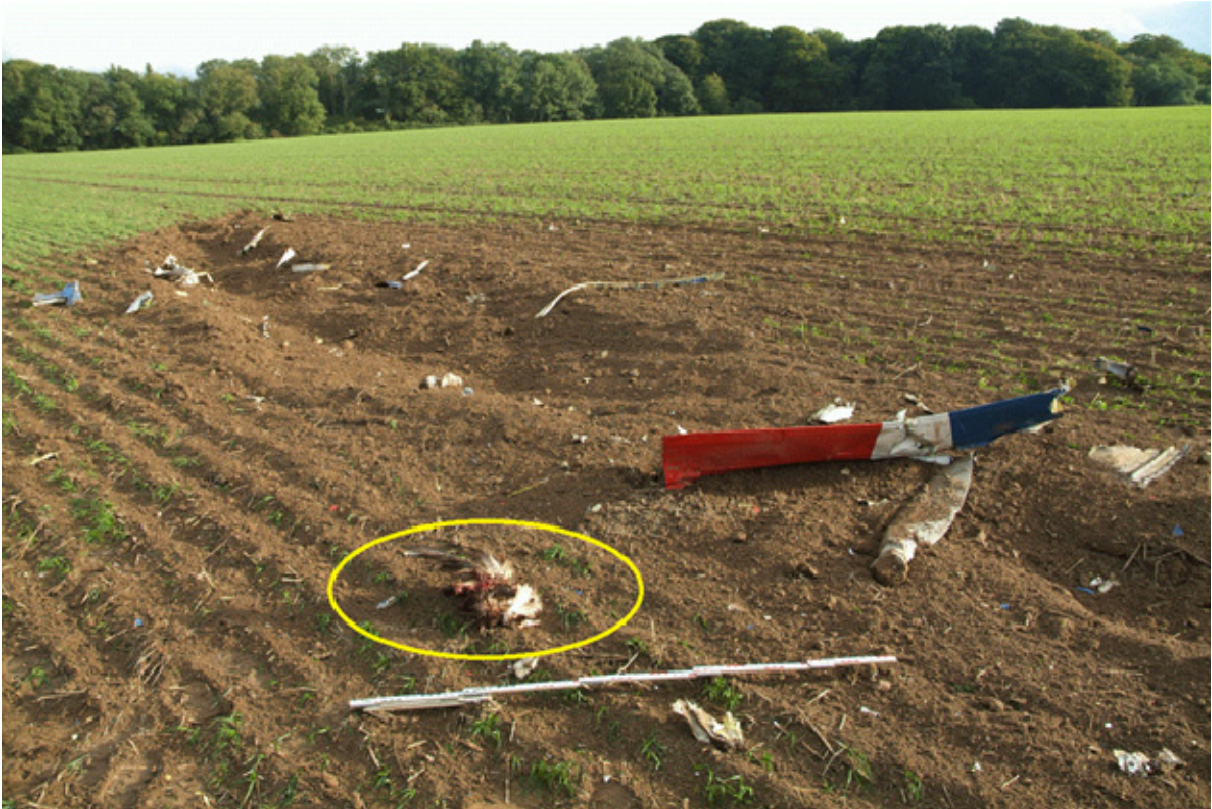
Unfallstelle, Blick in südöstliche Richtung, Vogelkadaver, linkes Querruder und Propellerblatt
