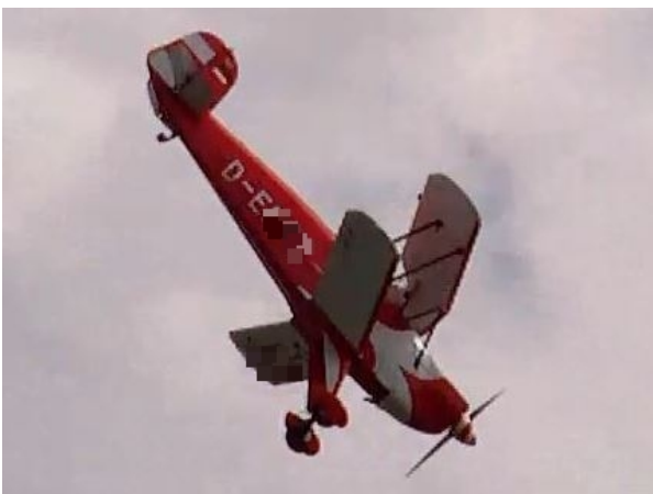
Fluglage und Ruderpositionen im Abfangbogen
