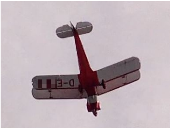
Fluglage und Ruderpositionen nach 4 \frac{1}{4} und 4 \frac{3}{4} Umdrehungen
