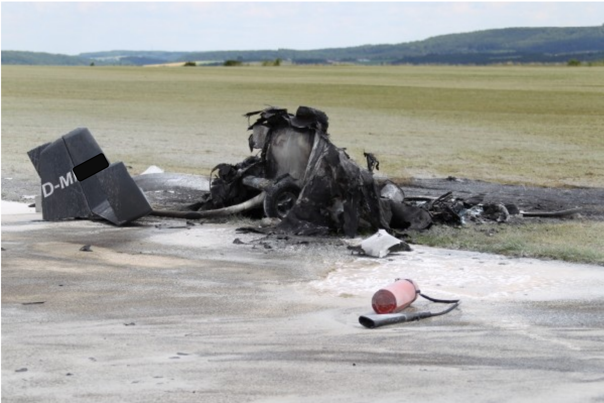
Brandschaden am Wrack
