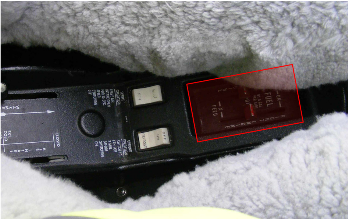
Tankwahlschaltung „versteckt“ unter den Sitzbezügen
