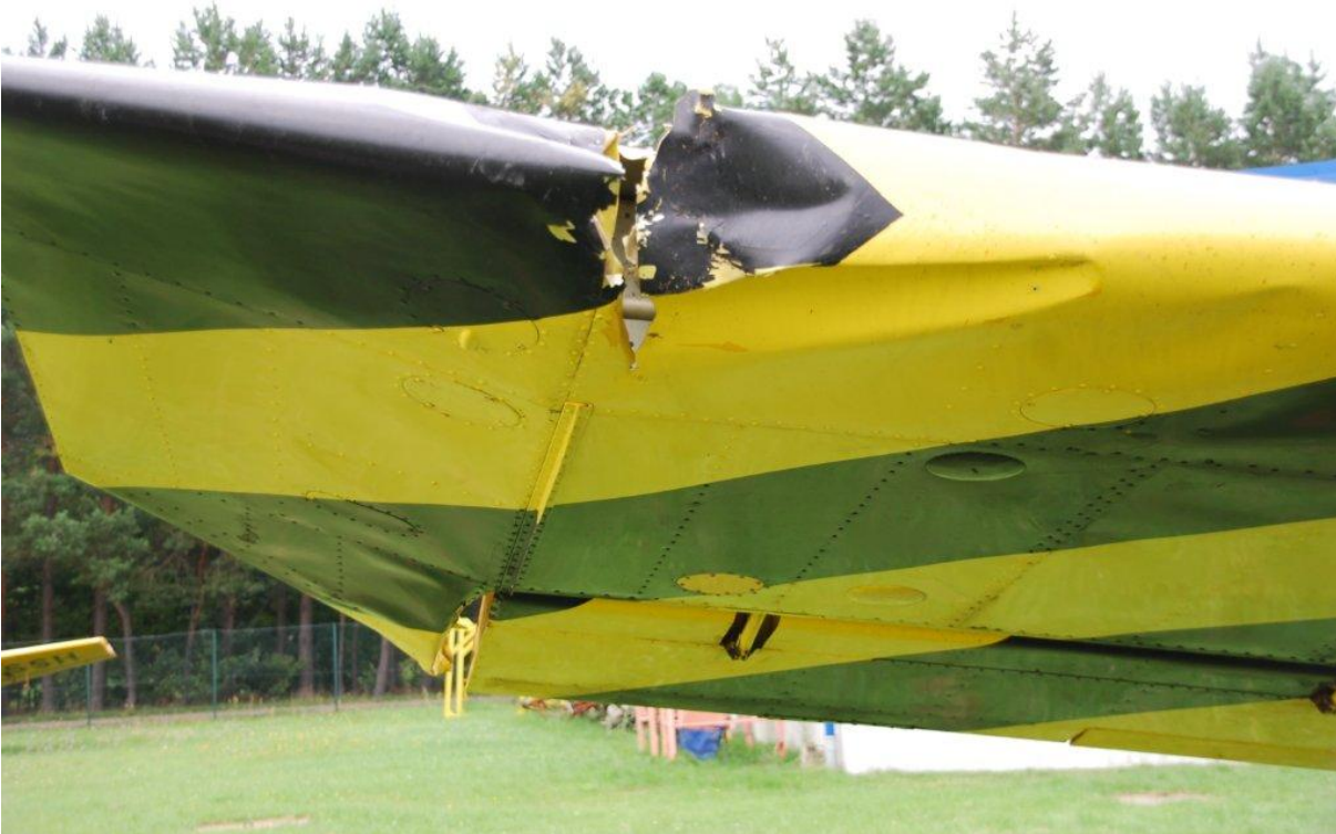
Kollisionsschaden am rechten Außenflügel
