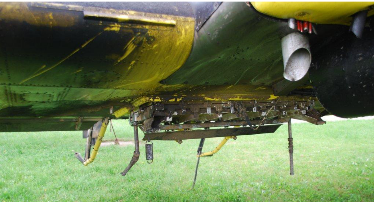
Kollisionsschäden an der Streuanlage
