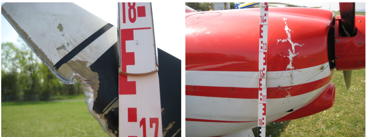
Beschädigungen am Propellerblatt und der Motorhaube
