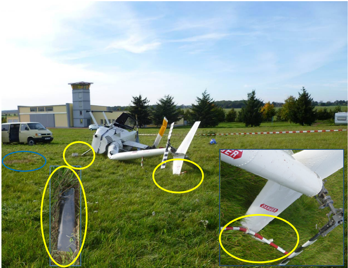
Hubschrauber mit abgebrochenem rechtem Kufenende und hoch gebogenem Sporn
