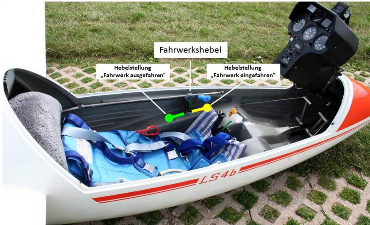
Fahrwerkshebel in mittlerer Position nach dem Unfall
