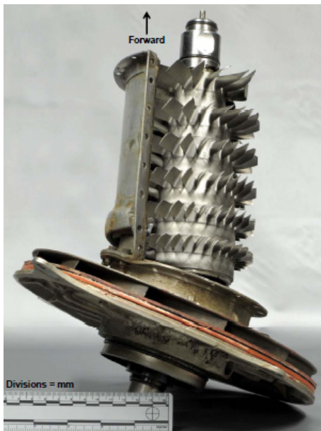
Kompressor mit verbogenen Schaukeln entgegen der Drehrichtung
