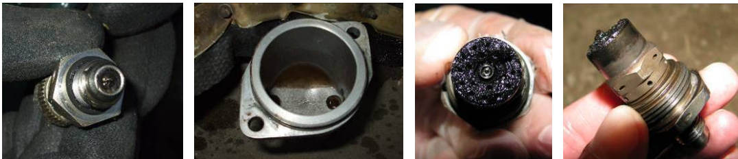
Detailaufnahmen Späne-Warn-Detektor, Kraftstofffiltergehäuse, Einspritzdüse Fotos: BFU
