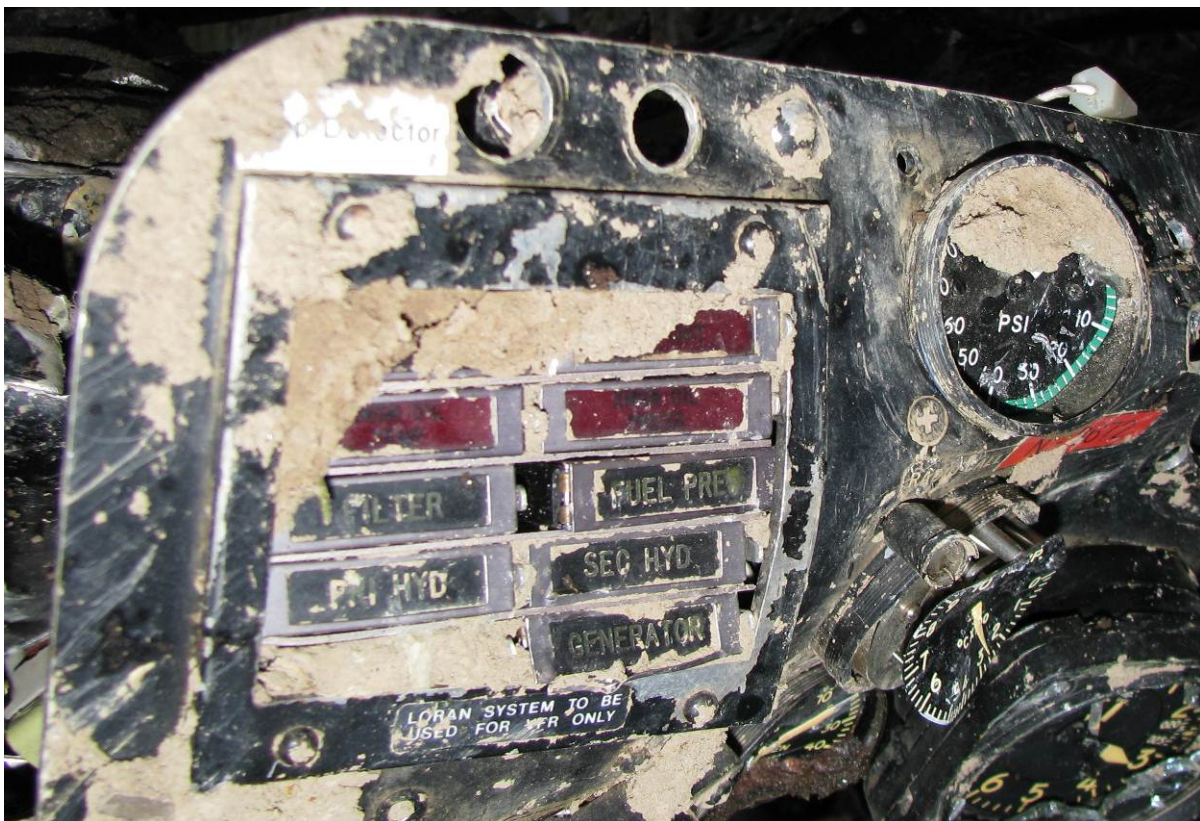
Caution Panel des Hubschraubers
