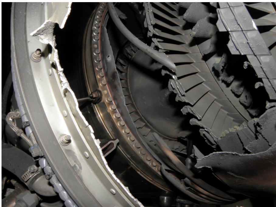
Beschädigtes Triebwerksgehäuse und Turbine
