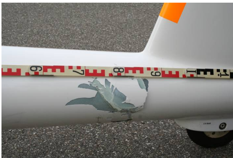
Beschädigung Rumpfröhre DG 300
