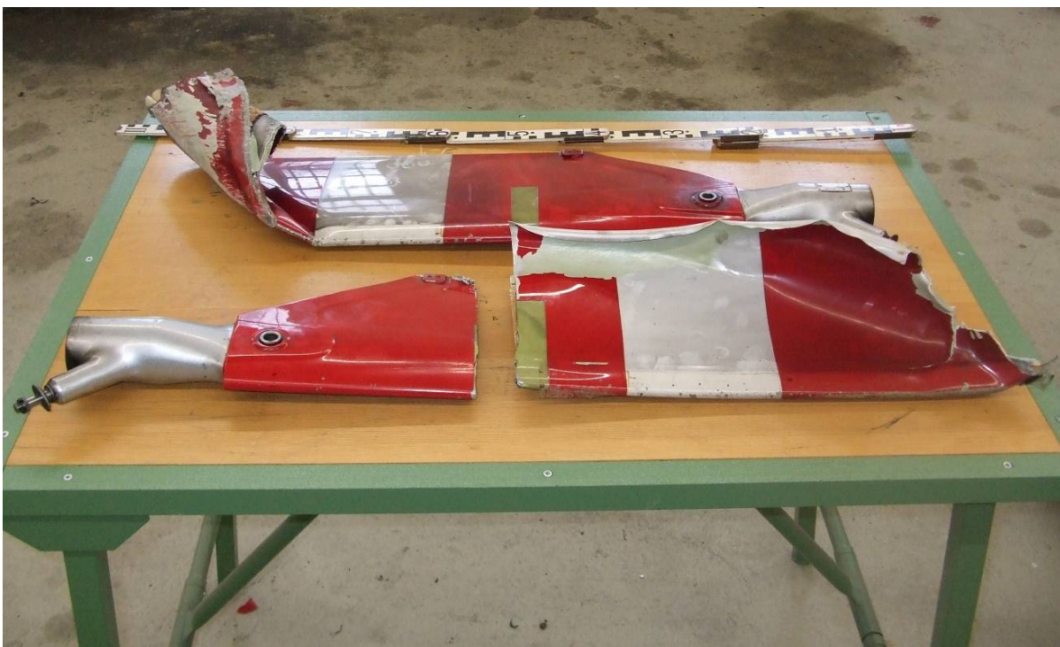
Anlage 2: Schaden am Heck des Hubschraubers und der Heckrotorblätter
