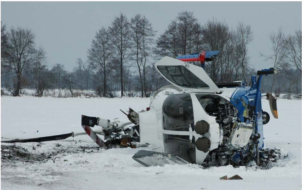
Unfallstelle mit abgerissenem Rotorkopf und Schaden am Rumpfbug
