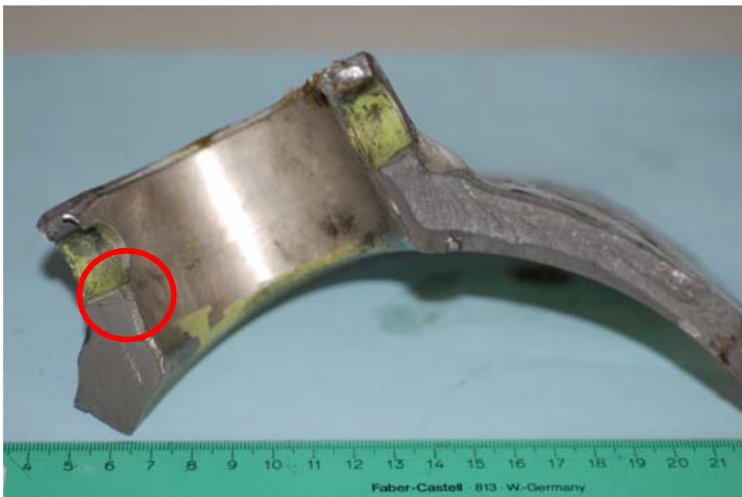
Abb. 4: Bruchstück mit Bruchausgangsbereich
