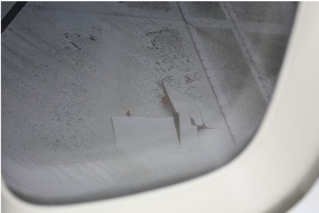
Abb. 2: Durchschlagene R/H Tragfläche, Blick aus dem Fenster
