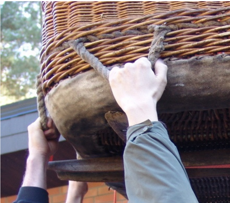
Versuch: Die Finger werden zwischen Korbwand und Seil eingeklemmt
