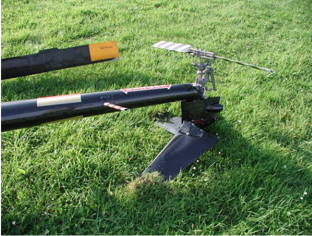
Entgegen der Bewegungsrichtung abgescherte Finne Foto: BFU
