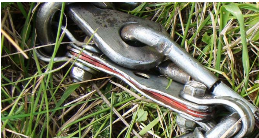
Sollbruchstelle im verwendeten Schleppseil
