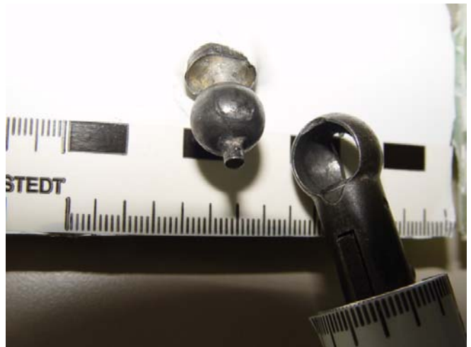
Hotellierverschluss am Höhenrudergestänge
