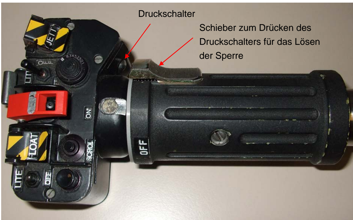
Detailaufnahmen der Stoppvorrichtung des Drehgasgriffs
