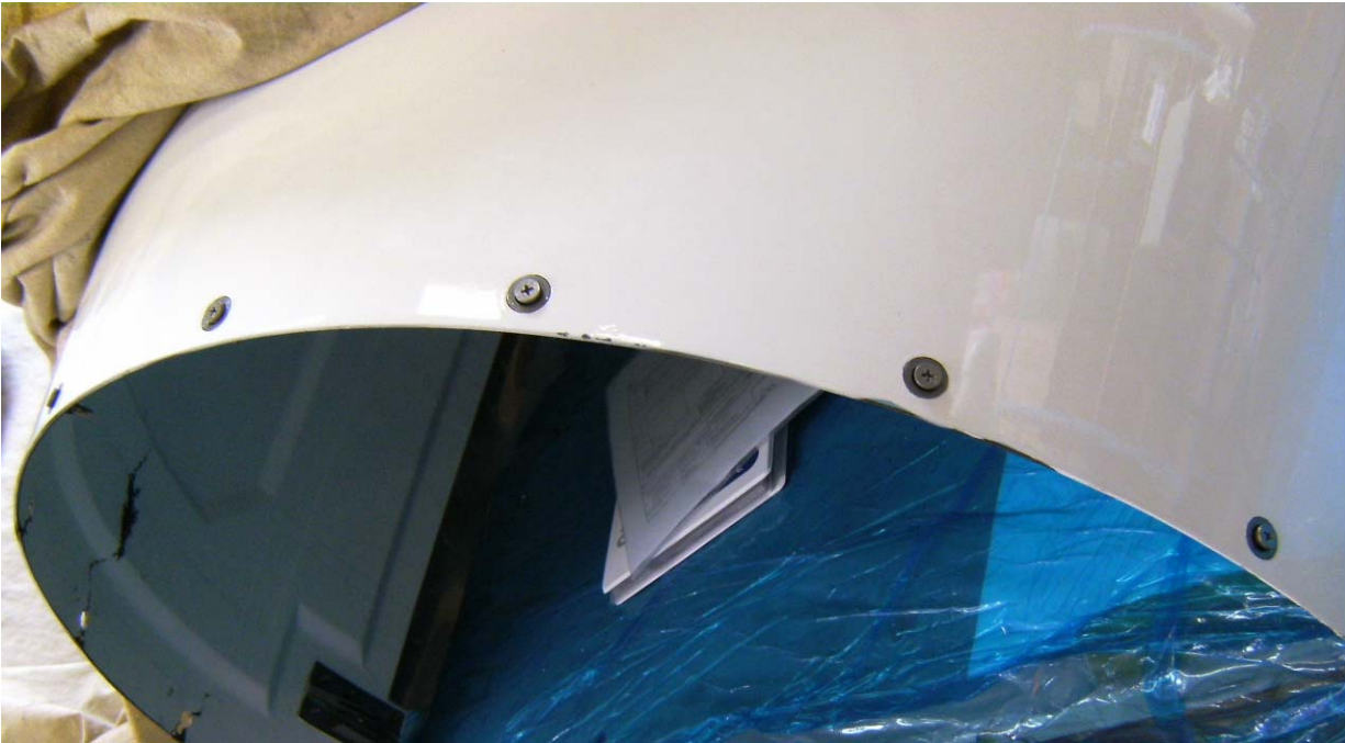
Teil der Cowling mit unbeschädigten Befestigungselementen
